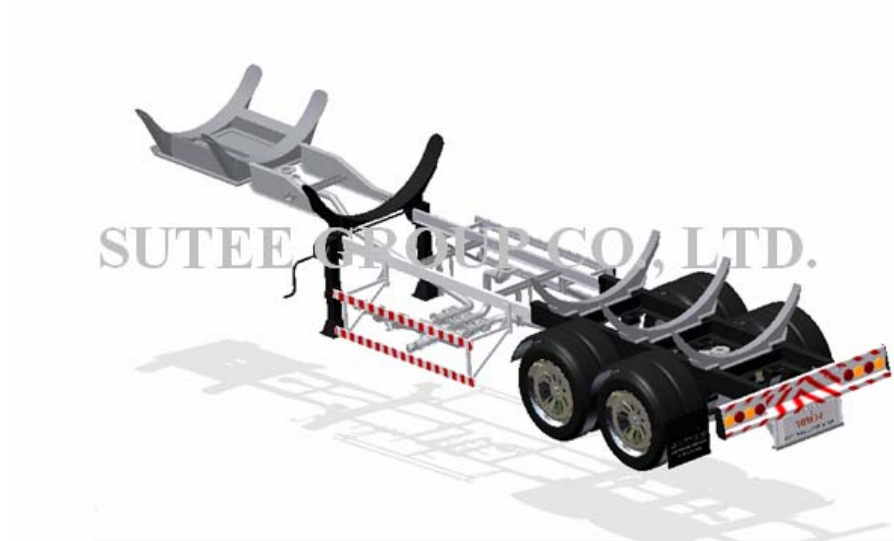
ภาพโครงสร้างหลัก(Chassis) ช่วงล่างและระบบท่อของรถบรรทุกสารเคมีขนาดใหญ่
